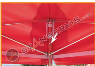
5. Konečnou fázou rozkladania strechy je posunutie klzného vedenia dohora tak, aby guľôčka osadená v nohe zapadá do otvoru v klznom vedení. Pri skladaní stánku najprv stlačte guľôčku.
